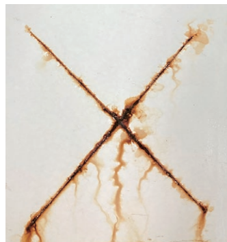
当社弱溶剤変性エポキシ樹脂下塗り塗料 (60µm×2回)
